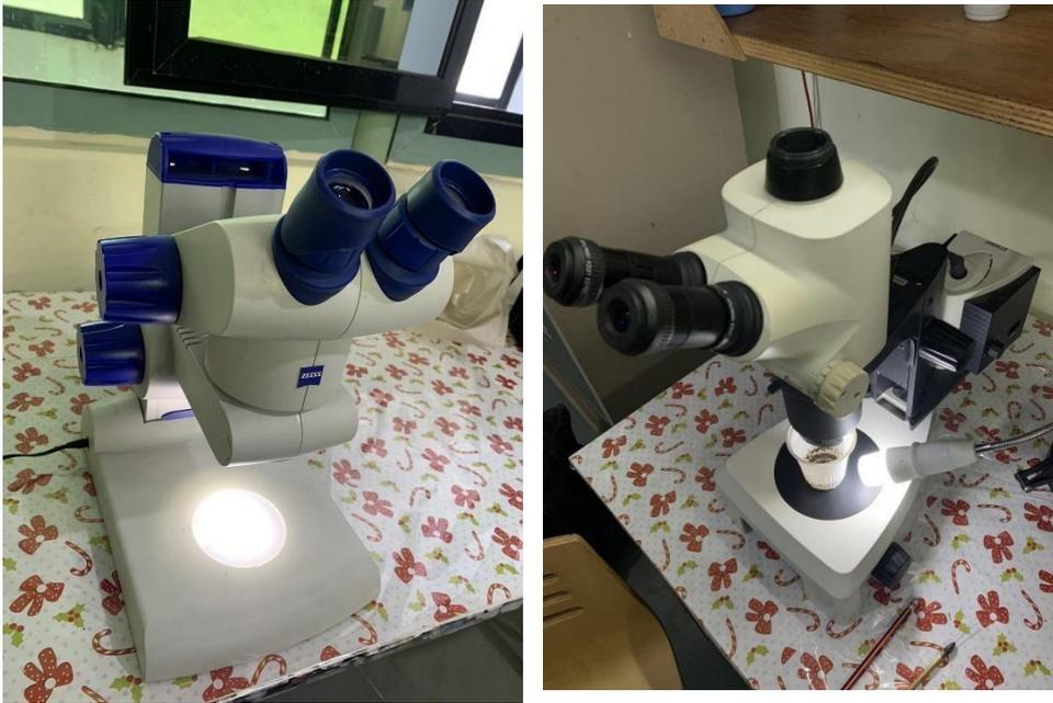
**Figure 17** : Loupe binoculaire De marque « Carl Zeiss » à grossissement X32 (Photo originale).
